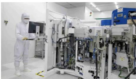
В Китае запущена первая производственная линия по выпуску фотонных чипов на основе тонкопленочного ниобата лития. Проект реализован научным центром CNIPX при Шанхайском университете. Линия, рассчитанная на работу со 150-мм подложками, оснащена более чем сотней единиц оборудования, включая системы фотолитографии, травления, нарезки и упаковки. Приобретение оборудования за рубежом стало возможным благодаря соответствию техническим требованиям, не нарушающим действующие санкционные ограничения.
