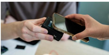
Ученые МФТИ и компания «СМАРТС Кванттелеком» разработали компактный, энергонезависимый аппарат для квантового распределения ключей. Устройство, размером с пейджер, значительно упрощает управление криптографией. Система генерирует криптографические ключи на основе случайных чисел и передает их по квантовым каналам связи через NFC-интерфейс на мобильные устройства. Это исключает посредников и повышает безопасность по сравнению с традиционными системами, где ключи хранятся централизованно.
